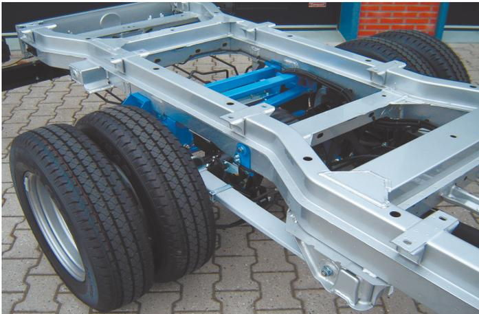
Pour le Sprinter 5,0 T 4x4 de Mercedes-Benz une suspension pneumatique pour l'essieu arrière est disponible. Le Sprinter est extrêmement qualifié pour l'utilisation d'une suspension pneumatique. Le VB-FullAir 2C est à monter sur des véhicules neufs comme pour des véhicules déjà livrés et sur la route et à vendre chez les partenaires VB ou les concessionnaires Mercedes.
