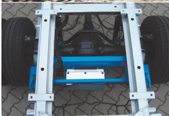
*avec VB-FullAir suspension pneumatique pour liessieu arrière*
